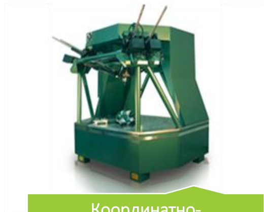
Координатно- измерительная машина КИМ-1200
